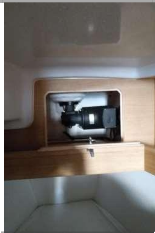
В носовой каюте находится якорное устройство
